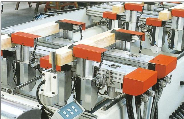
Komplette Einzelteilbearbeitung in einer Aufspannung für hohe Maßgenauigkeit
